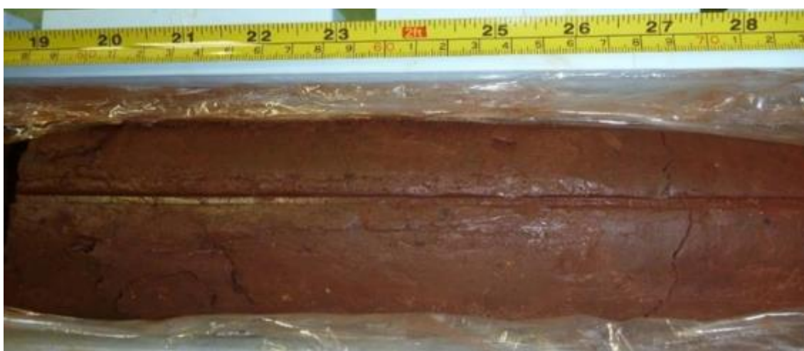
Figure 7-4: SDD014 0.5 m AV (Red Haematitic Clay)
